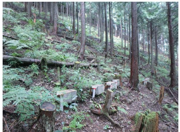
図-4 山腹部のヒノキ人工林に設置した土砂受け箱
