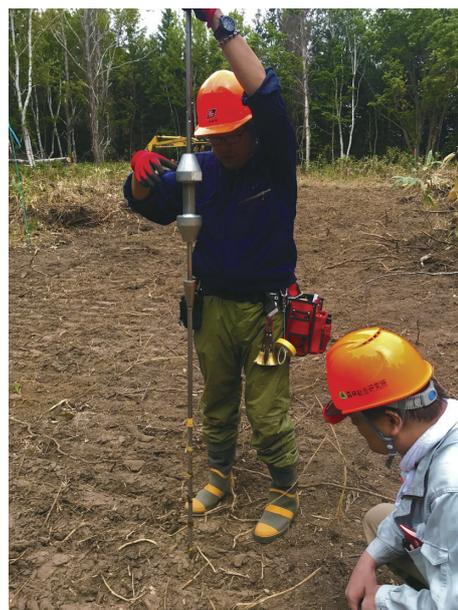
写真-4 土壌の締め固めを調べるための調査
