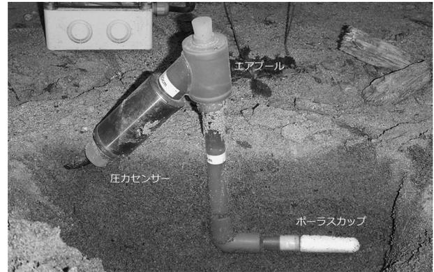
写真-1 エアプール式テンシオメーター、設置状態の断面
