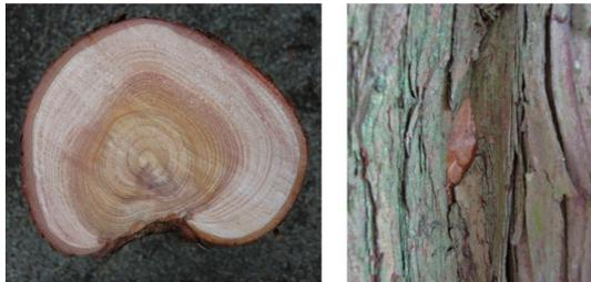
写真-3 サワラの溝腐れ部の横断面（左）と溝
