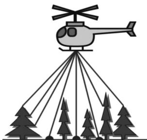
図-1 空中レーザー測量の模式図
