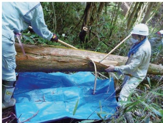
写真-1 樹皮の剥離作業。木材の試料を採取する前に汚染度の高い樹皮を剥離する。
