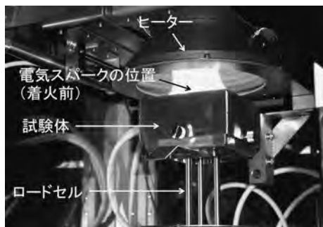
写真-1 コーンカロリメータ試験
