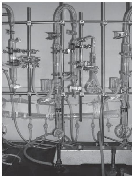
写真 Johnson & Nishita の蒸留装置
