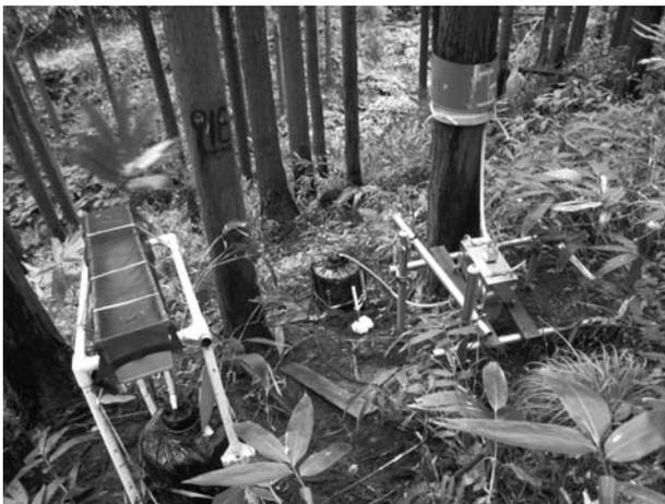
写真-5 酸性雨モニタリングのための林内雨、樹幹流の測定装置
