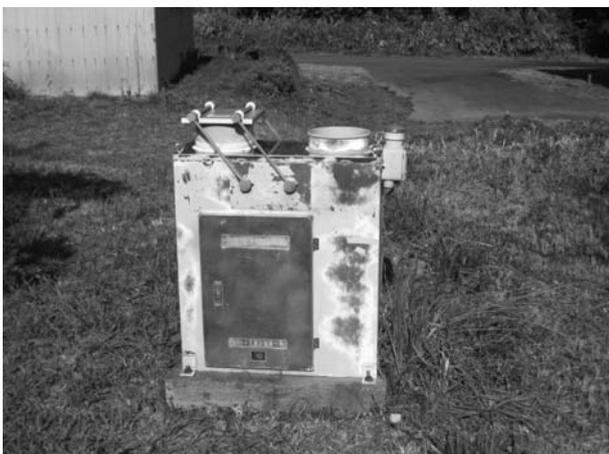
写真-6 多根団地の酸性降下物分別採取装置
