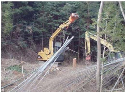
図-4 スイングヤード (左) とグラップルローダ (右) による集材作業
