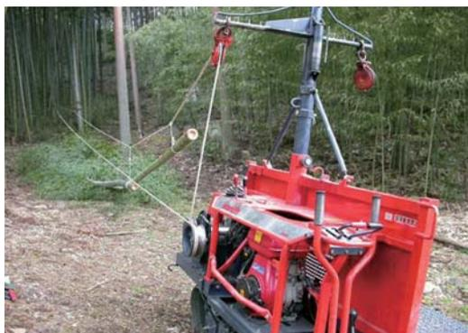
図-6 単線循環式による集材作業
