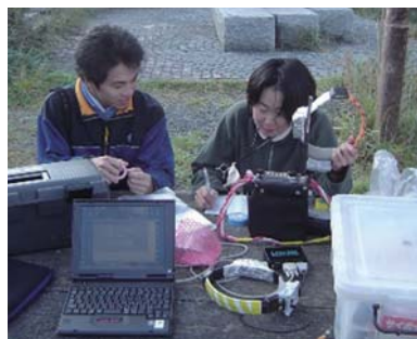
写真-2 GPSテレメトリー機材の セットアップ風景
