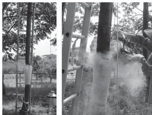
図-3 立木凍結法の実際 樹幹に取り付けた漏斗に液体窒素を注ぎ樹幹を凍結させ、凍結後に伐採する。
