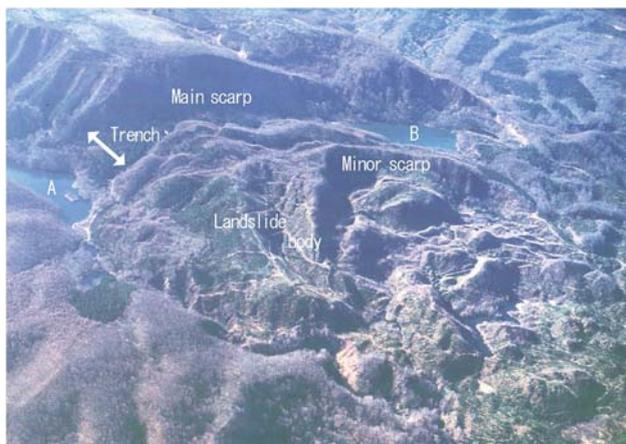
写真-2 船形連峰北麓に発生した大規模な岩盤層スベリによる地すべり地形
