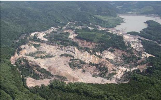
口絵-3 荒砥沢ダム上流の大規模地すべりの全景(移動方向に直行する2列のリッジが見える、右奥が荒砥沢ダム貯水池)(第Ⅰ章参照)
