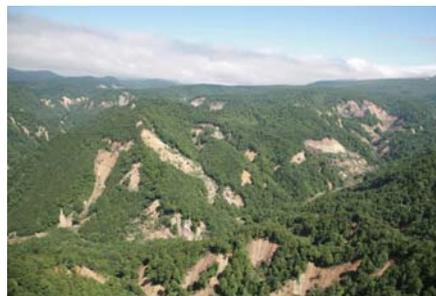
写真-2 岩手・宮城内陸地震時の斜面崩壊 (撮影：岡本隆氏)
