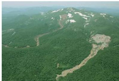
写真-1 ヘリ調査により不安定な土砂が溪流に多く残存していることが確認された産女川上流の崩壊地(岩手県一関市)
