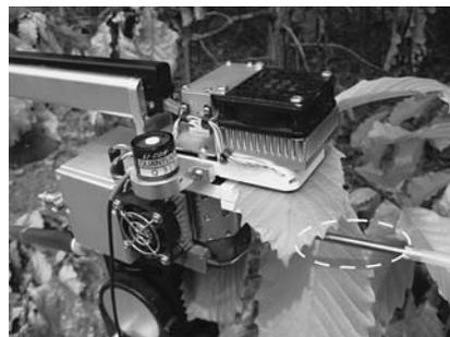
図-1 葉からの揮発性有機化合物の放出量測定の様子（点線の金属管内の吸着剤に採取）
