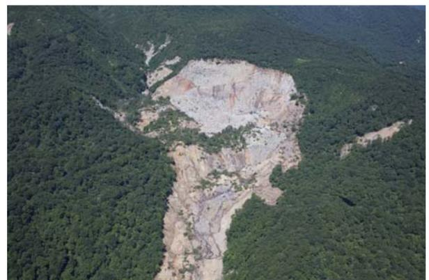
写真-2 磐井川支川産女川に発生した巨大崩壊（1,000万m<sup>3</sup>を越える崩落土砂が川を堰き止めている。堰き止め土塊から湧出する水脈が見える。最近、滑落崖背後に大きな開口亀裂が見つかった。）
